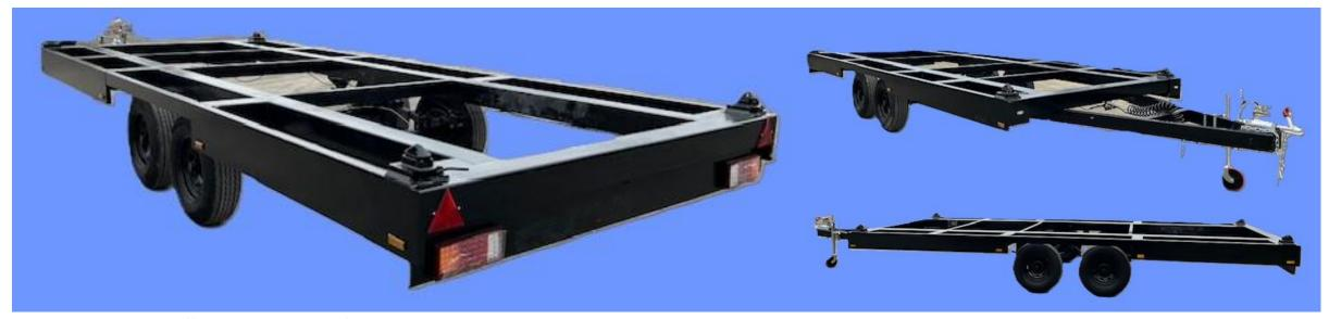
油圧慣性ブレーキ付きコンテナフルトレーラー 車検対応済み
